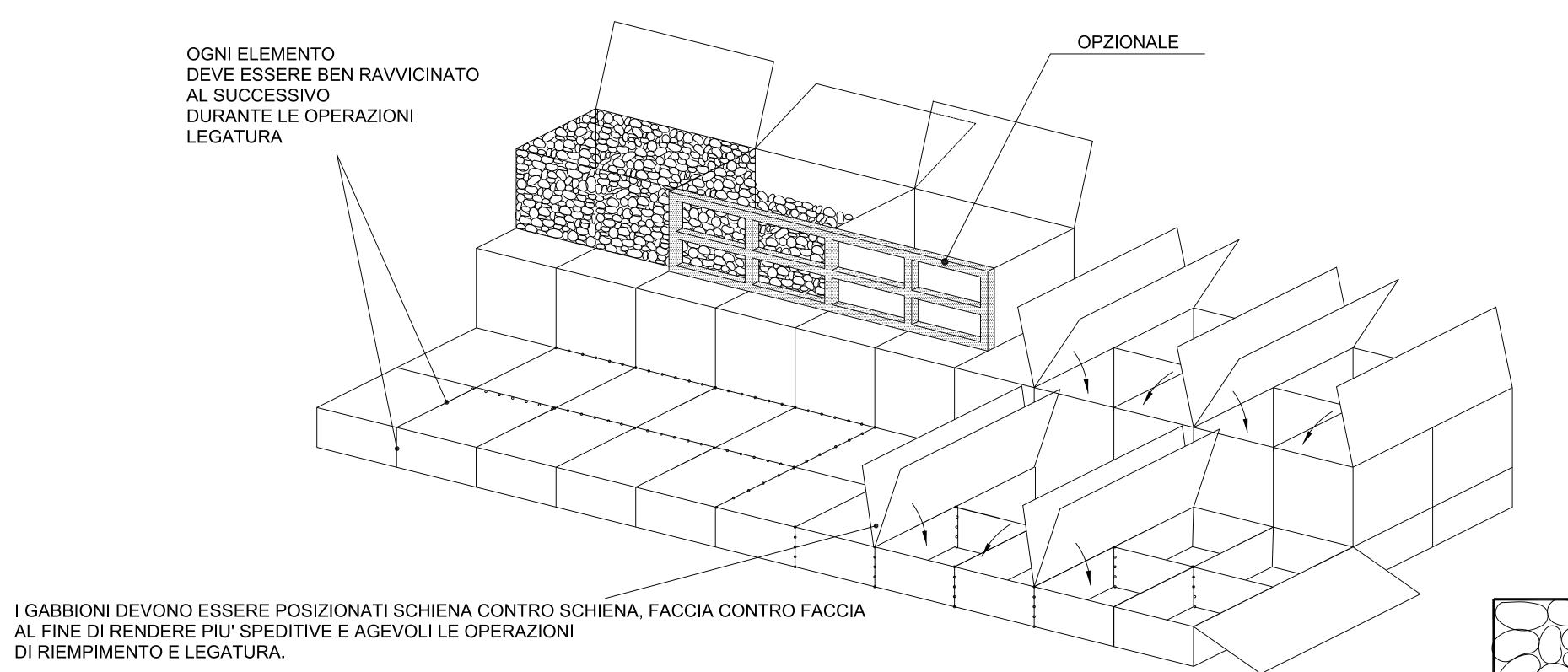
I GABBIONI DEVONO ESSERE RIEMPITI CON MATERIALE LAPIDEO NON GELIVO, CON PEZZATURA NON SUPERIORE A 250 mm E DI DIMENSIONI NON INFERIORI A QUELLE DELLA MAGLIA; LE DIMENSIONI OTTIMALI VARIANO TRA 75 mm E 200 mm.
